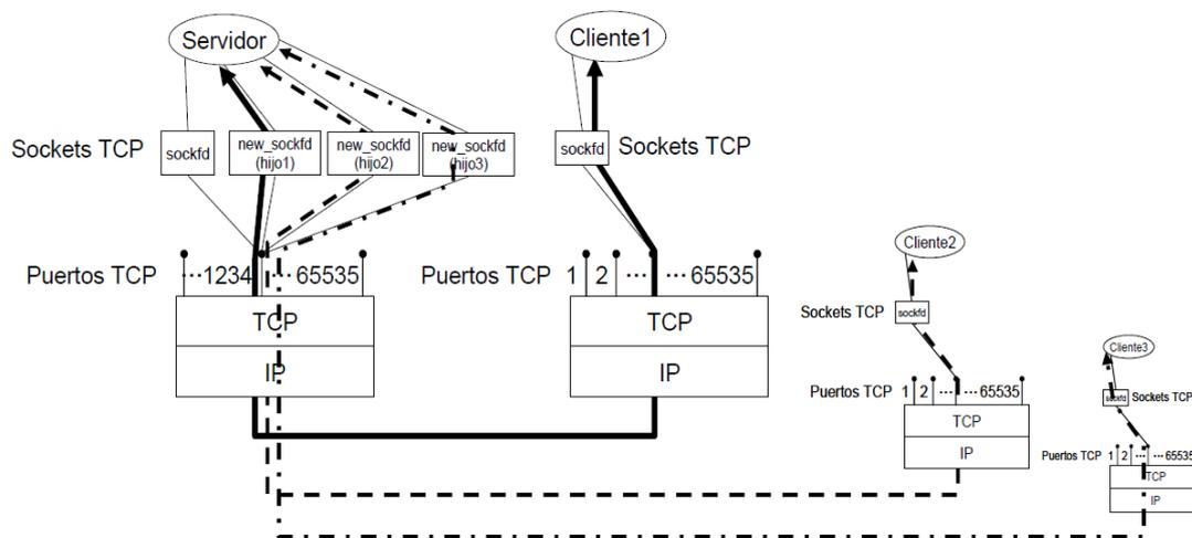
Figura 3-1: Conexiones en un servidor TCP concurrente
