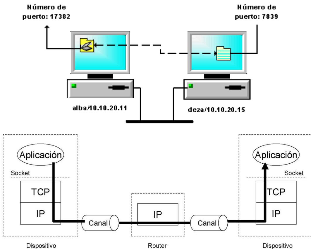
**Figura 2-1: Comunicación entre aplicaciones en una red TCP/IP**
