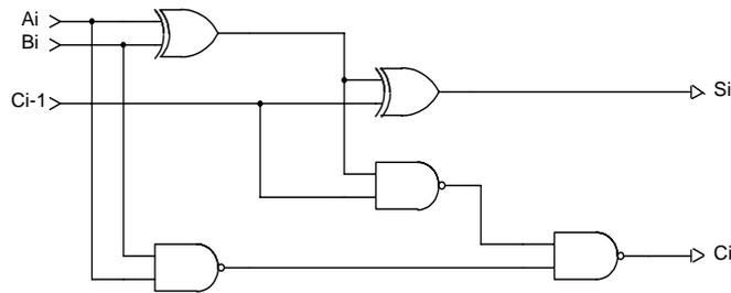
Utilizando como componentes el modelo de una puerta XOR y una puerta NAND tendríamos la siguiente implementación VHDL para el sumador elemental:
