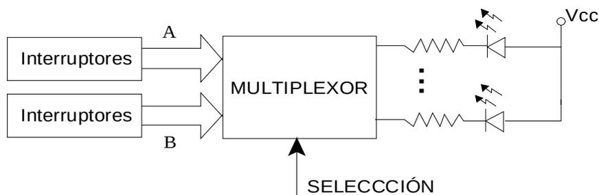
Figura 1. Diagrama de bloques del montaje del multiplexor.
