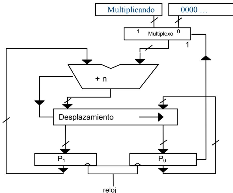
Figura 3. Multiplicador mediante el algoritmo de sumas-restas
